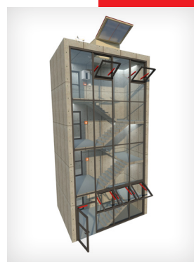
SYSTEMY ODDYMIAJĄCY KŁATEK SCHODOWYCH
